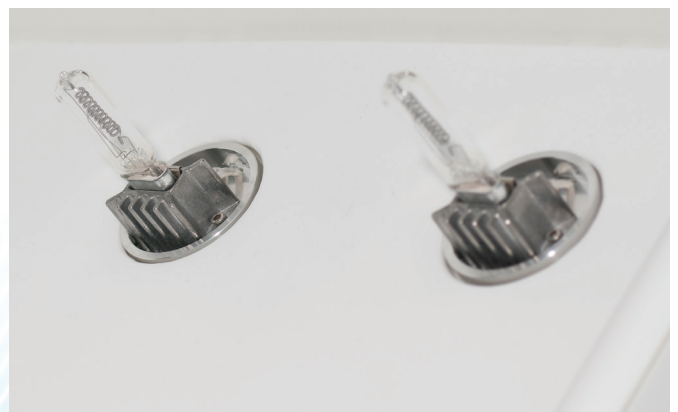
Halogenlampen in der 2500 mm Ulbrichtkugel
